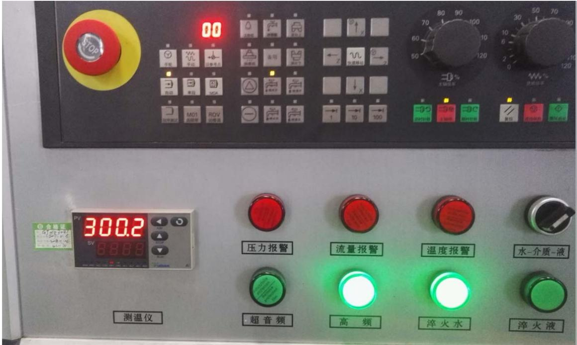
**1.1 急停：**按下急停按钮，所有动作停止输出，系统复位。急停按下后系统所有其它按键不再有效，旋转按钮后解除急停。
